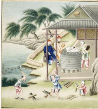
19 Seconde cuisson dans un four fermé (feu de moufle fermé)
