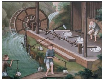
3 Concassage du Kaolin par des marteaux en bois actionnés par une roue hydraulique
